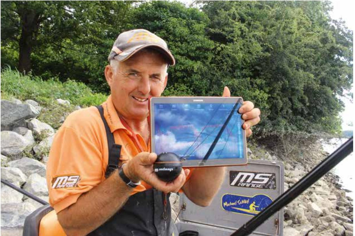
Mit dem Deeper Echolot und dem Tablet wird die Bodenstruktur des Gewässers genau erkundet.
